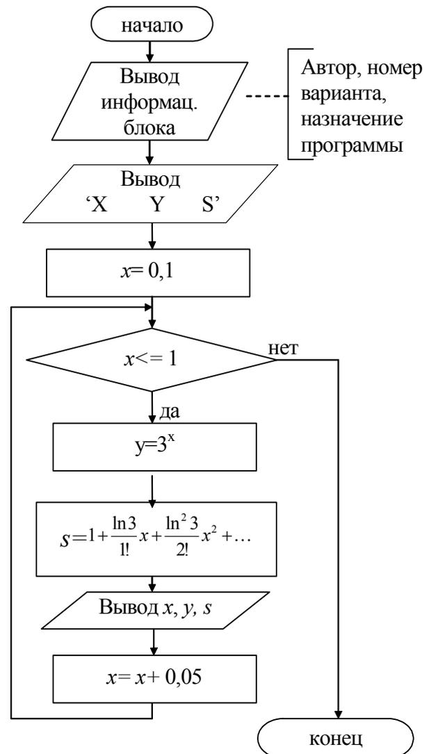
Рис. 4.1. Общая блок-схема задачи табулирования функций
