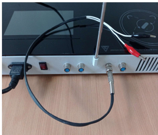
Рис. 4.16. Подключение устройств для электролиза
