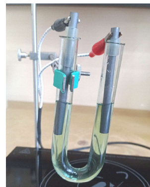
Рис. 4.19. Сборка электролизера для опытов 2 и 3
