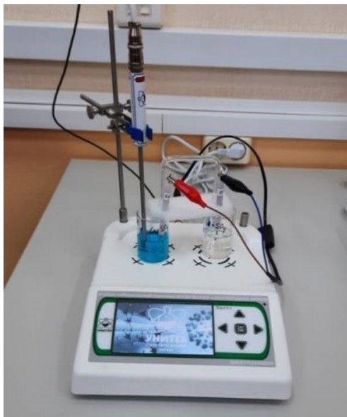
Рис. 3.9. УЛК «Электрохимия» с растворами солей, соединенными солевым мостиком
