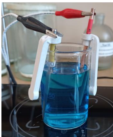
Рис. 5.6. Образец сборки электролизера для опытов 4–5.
