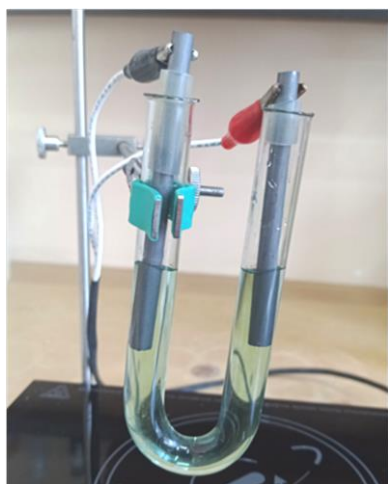
Рис. 5.4. Образец сборки электролизера для опытов 1, 2.
