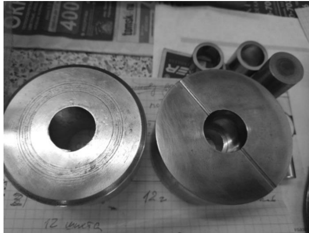
Рисунок 2.1 – Пресс-форма для изготовления образцов тороидальной формы
