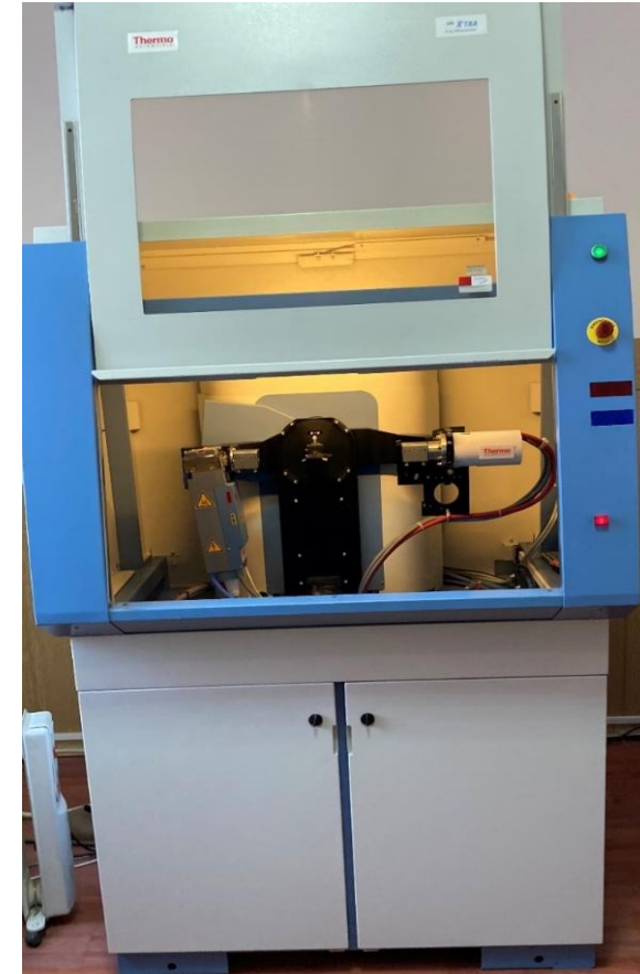
ARL X'TRA – дифрактометр напольного типа. Проведение качественного и количественного фазового анализа поликристаллических проб
