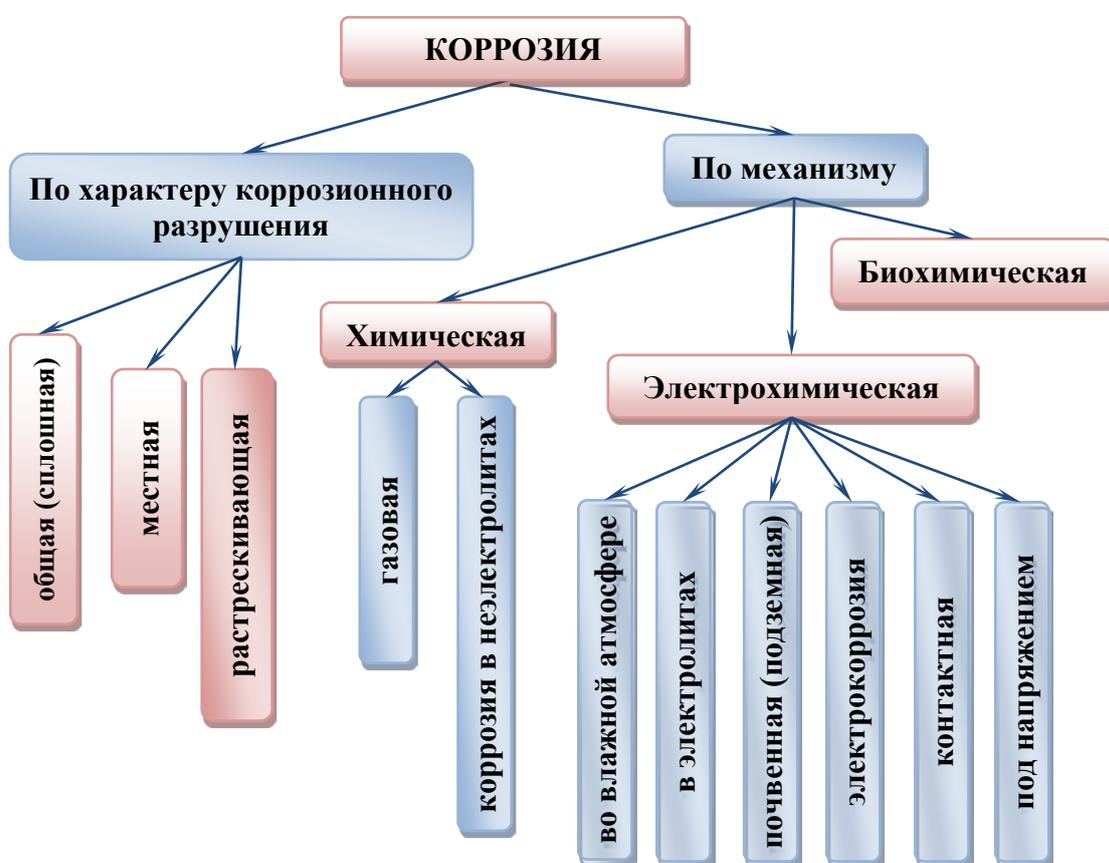
Рис. 1.1. Классификация коррозионных процессов
