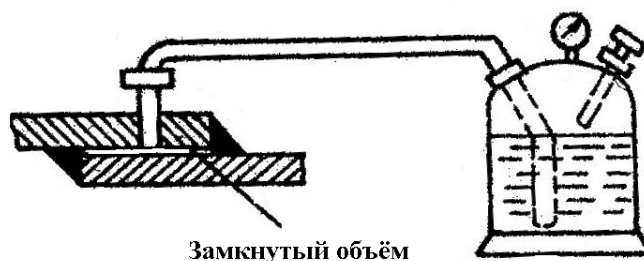
Рис. 8. Схема испытаний на плотность сварных швов воздухом
