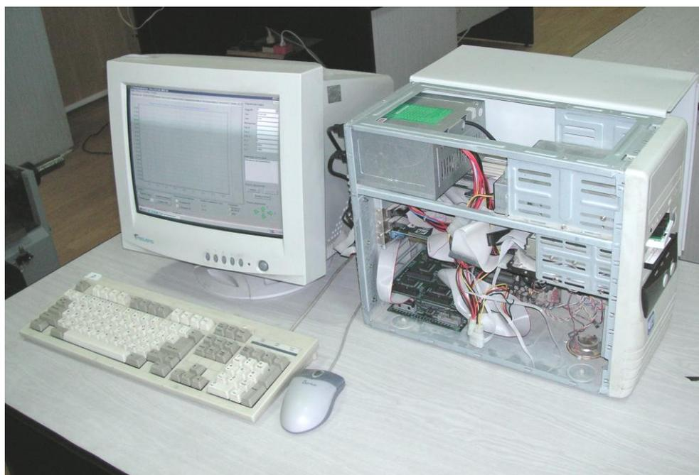
Рис. 2.11. Вид ПК с установленными платами ввода/вывода
