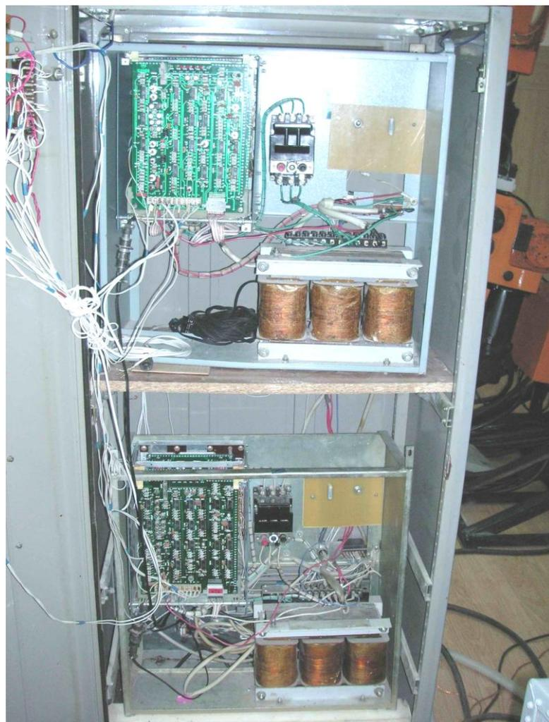
Рис. 2.12. Вид шкафа с электроприводами с открытой дверцей
