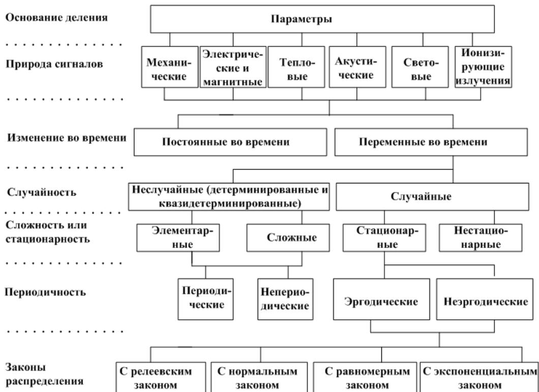
Рис. 1.12. Классификация параметров по видам измерительных сигналов
