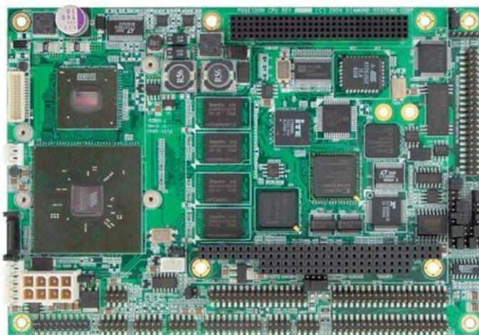
Рис. 4.8. Одноплатный высокопроизводительный компьютер Poseidon формата ЕРІС с интегрированным модулем УСО фирмы DIAMOND SYSTEMS
