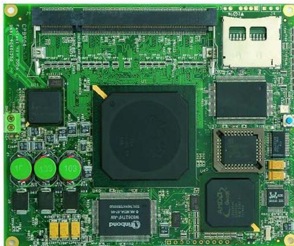
Рис. 4.9. Одноплатный компьютерный модуль CPB904 фирмы Fastwel стандарта ETX с низким энергопотреблением и компактными габаритными размерами 114×95 мм
