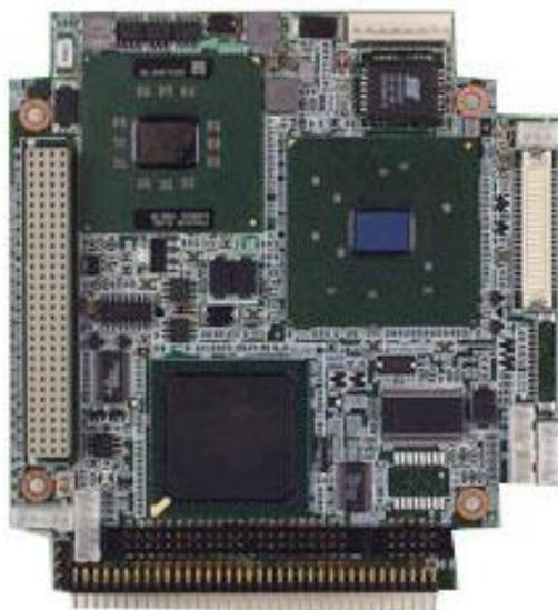
Рис. 4.7. Одноплатный компьютер стандарта PCI/104 PCM-3380 фирмы ADVANTECH
