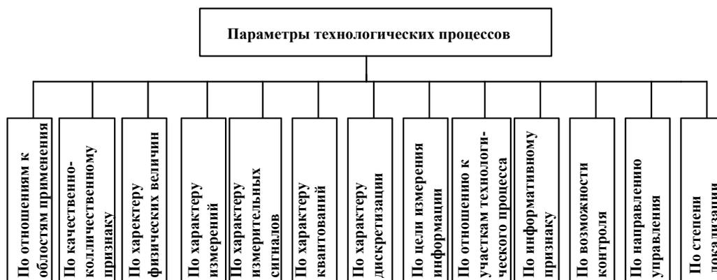
Рис. 1.9. Классификационные признаки параметров технологических процессов
