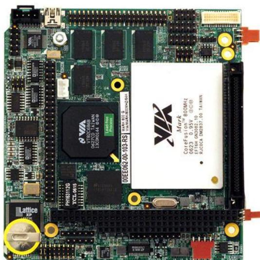
Рис. 4.5. Одноплатный компьютер стандарта Athena II фирмы DIAMOND SYSTEMS
