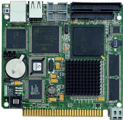
Рис. 4.14. Высокопроизводительная процессорная плата в формате MicroPC с поддержкой Ethernet и CompactFlash фирмы Fastwel CPU686E
