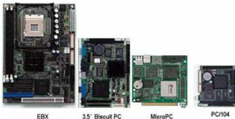
Рис. 4.4. Одноплатные компьютеры различных формфакторов
