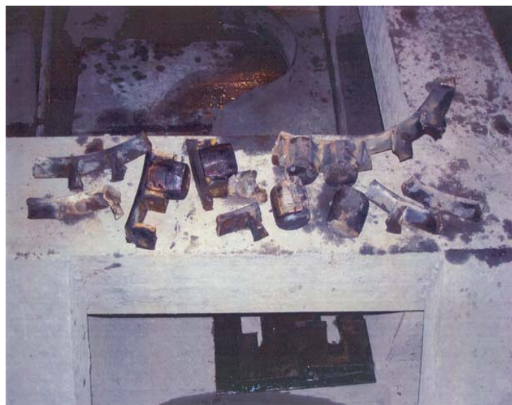
Рис.1.36. Фрагменты разрушенного подшипника
