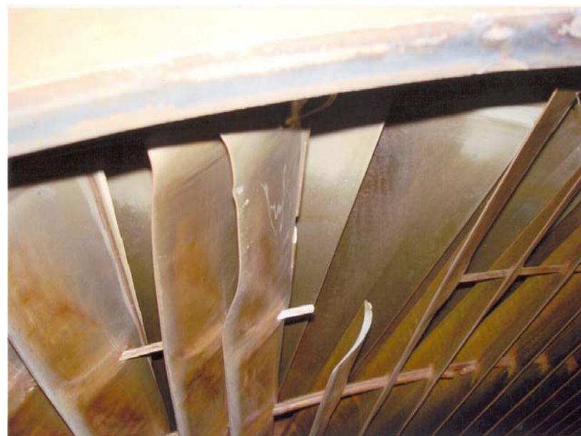
Рис. 1.18. Облом лопатки РНД
