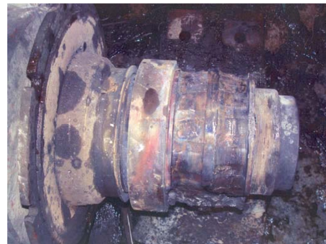
Рис. 1.34. Ротор поврежденного подшипника
