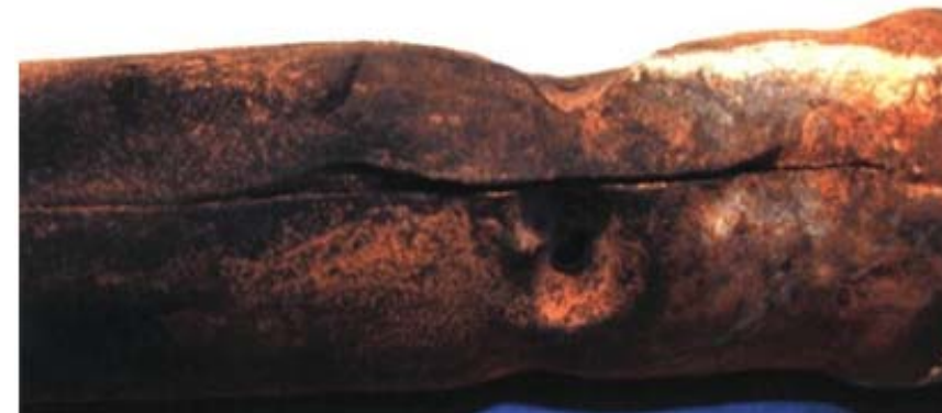
Рис.1.13. Трещина в змеевике конвективного пароперегревателя
