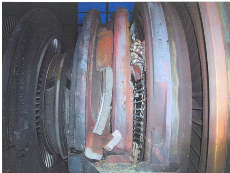
Рис.1.30. Вид диафрагмы после снятого корпуса
