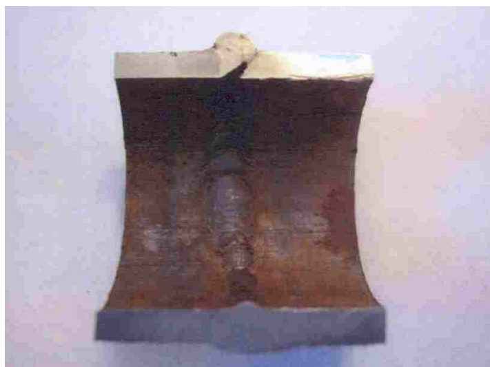
Рис. 1.3. Поперечный разрез дефектного сварного шва со свищом
