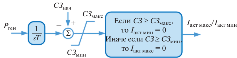
Рис. 6. Контур заряда-разряда в обобщенной модели АБ.
