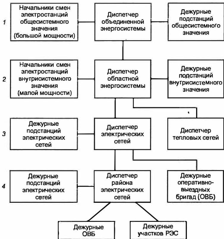
Рис. 1.1. Структура четырехступенчатой системы диспетчерского управления: 1–4 – уровни управления
