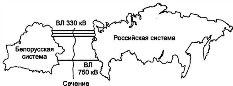
Рис. 3.43. Сечение электрической сети
