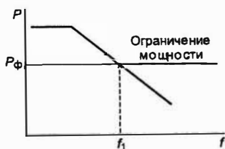
Рис. 3.64. Зависимость мощности генераторов от частоты
