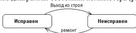
Рис. 6.1. Простейший пример диаграммы состояний для технического устройства типа компьютер
