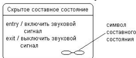
Рис. 6.9. Составное состояние со скрытой внутренней структурой и специальной пиктограммой
