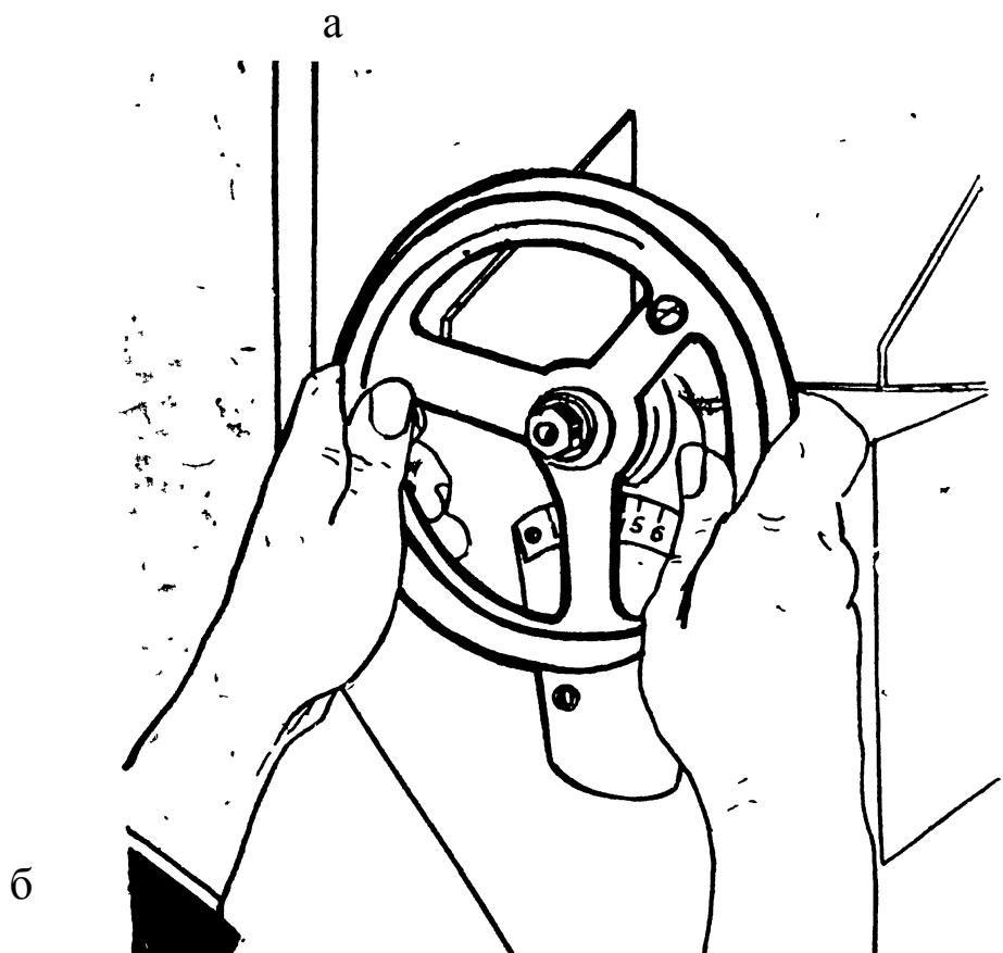
Рис. 4. Регулировка триерных цилиндров: а – положение рабочей кромки лотка в триерных цилиндрах; б – маховик поворота лотка триерного цилиндра
