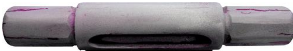
Рис. 3.5. Объект контроля с естественными дефектами
