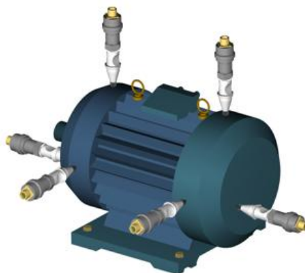
Рисунок 3.1 Пример расположения датчиков
