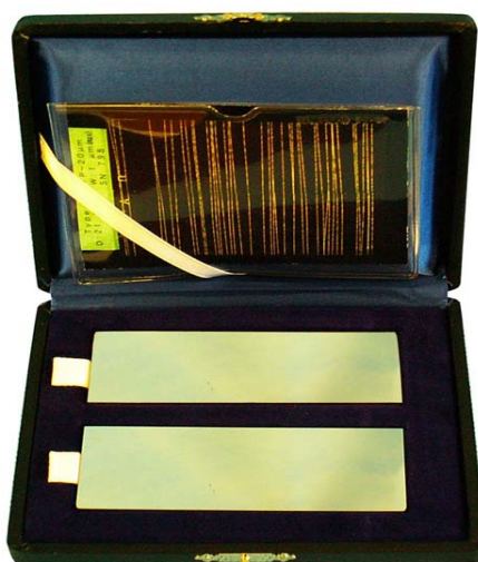
Рис. 7.2. Никель-хромовые тест-панели по JIS Z 2343 (на крышке футляра видна эталонная фотография)
