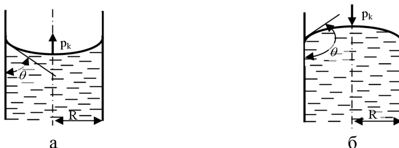
Рис. 1.4. Вогнутый (а) и выпуклый (б) мениски в капиллярных трубках, наполненных соответственно смачивающей и несмачивающей жидкостями
