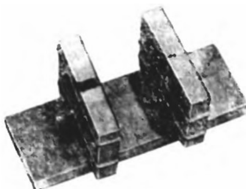
Рис. 6.6. Общий вид имитатора несплошностей, собранного из плиток Иогансона
