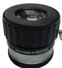
Рис. 3.1. Лупа измерительная ЛИИ 3-10 x
