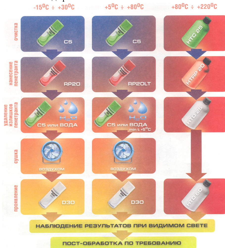
Рис. 1.3. Карта выбора средств Vucotest для цветного метода капиллярного контроля
