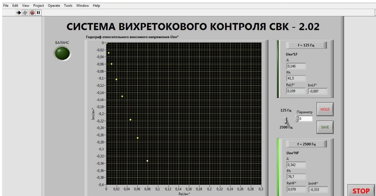
Рис. 8. Пример отображения результатов измерений СВК 2.02
