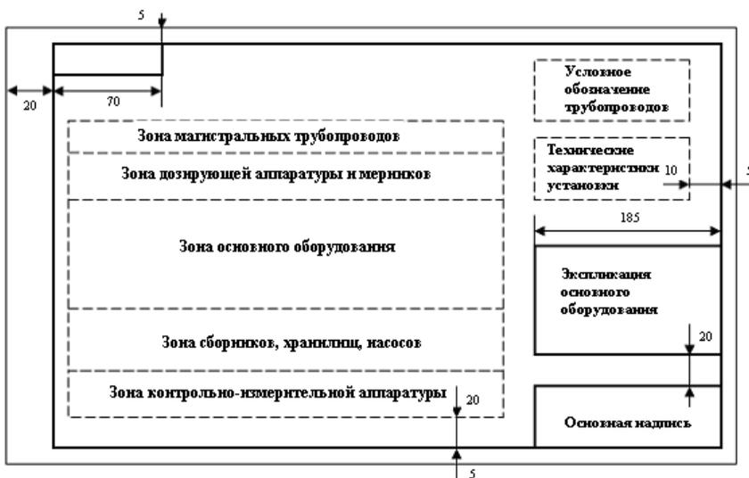
Рисунок 3 Рекомендуемое расположение элементов чертежа аппаратурной схемы
