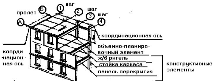
Рисунок 6 Объемно-планировочные и конструктивные элементы здания
