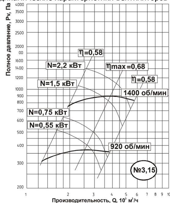
**Рис. 3.** Аэродинамические характеристики вентиляторов ВЦ 14-46-2
