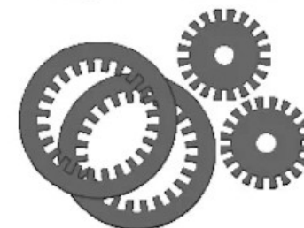
Листы магнитопровода статора и ротора асинхронного двигателя
