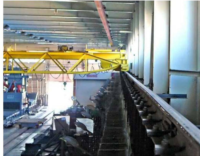
Механизм подъема и спуска груза размещен на крановой тележке. Состоит из приводного ЭД, трансмиссионных валов, горизонтального редуктора и грузовых тросов с барабаном для намотки.
