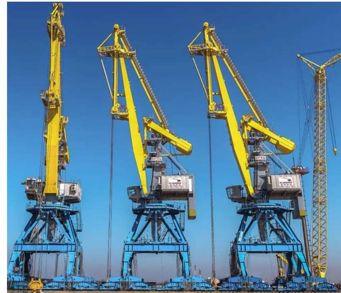
Поворотная часть крана, поворачивающаяся относительно портала на неограниченный угол, состоит из платформы, колонны и стрелового устройства. На поворотной части устанавливают механизмы подъема, поворота и изменения вылета стрелы, кабину крановщика и машинную кабину, а также электрооборудование.
