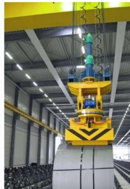
Управление механизмами крана - из кабины оператора-крановщика, в которой установлены контроллеры или командоконтроллеры. Для выхода на мост из кабины предусмотрен верхний люк, так как кабина размещена справа под мостом. Аппаратура управления и резисторы расположены на мосту.
