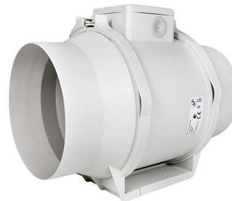
**Осевой** вентилятор состоит из цилиндрического кожуха и рабочего колеса лопастей, которые крепят к втулке под определенным углом к плоскости вращения. Колесо фиксируют на оси электродвигателя. Применяют в системах вентиляции благодаря простой конструкции, высокому КПД, высокой надежности. Недостаток: не могут создать высокое давление, что ограничивает область их применения.
