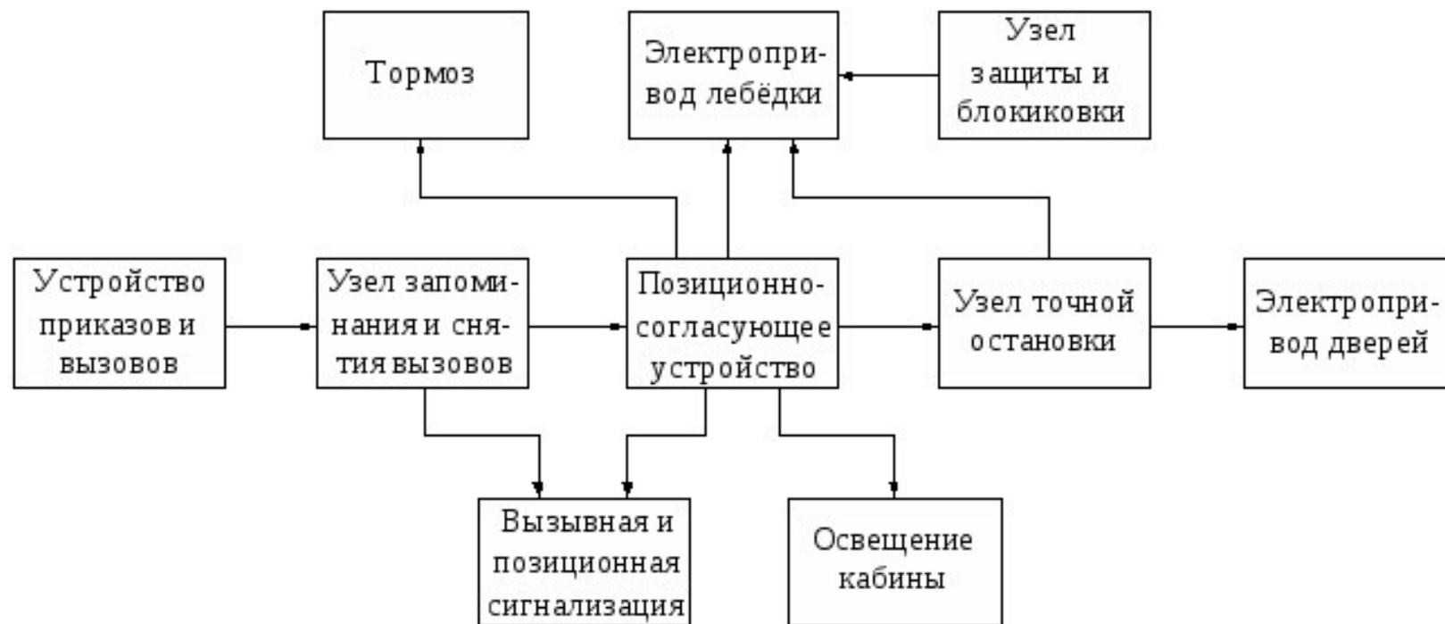
Структурная схема лифтовой установки
