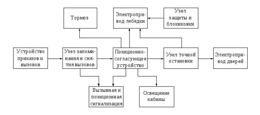
Структурная схема лифтовой установки
