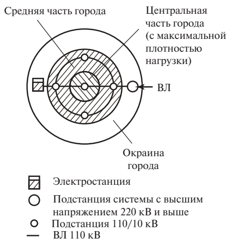
Рис. 4.19. «Идеальная» схема электроснабжения города
