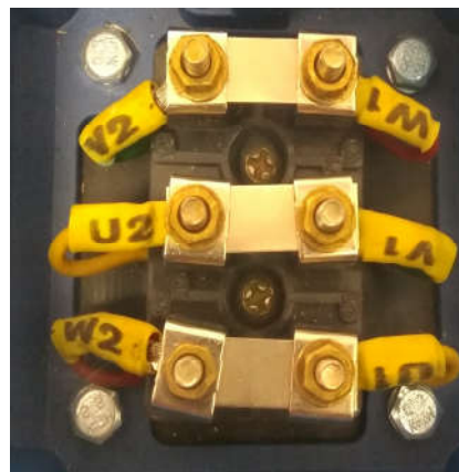
Соединение обмоток мотора по схеме «треугольник»
