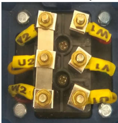
Соединение обмоток мотора по схеме «звезда»
