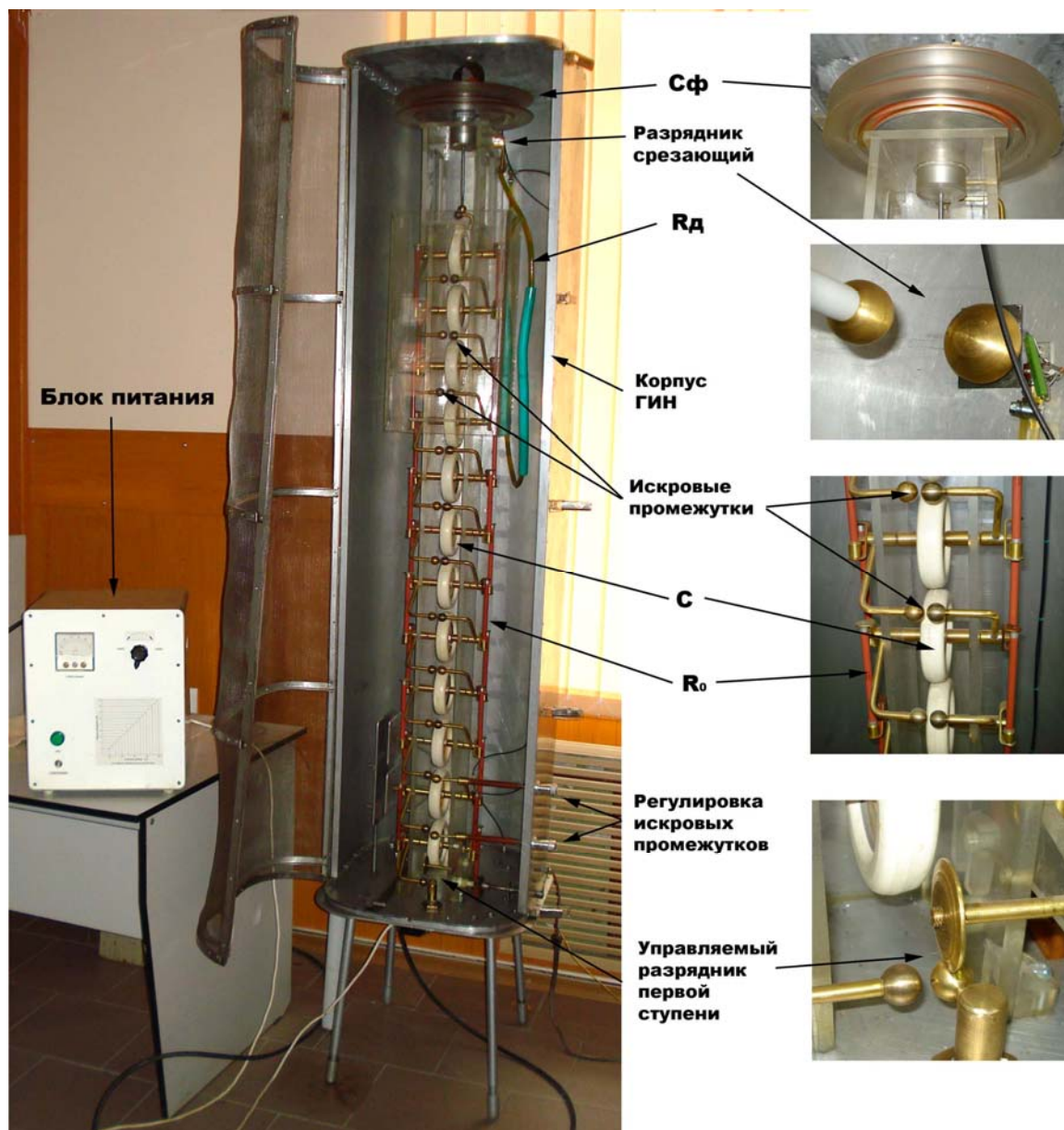
Рис. 10. Устройство ГИН.
