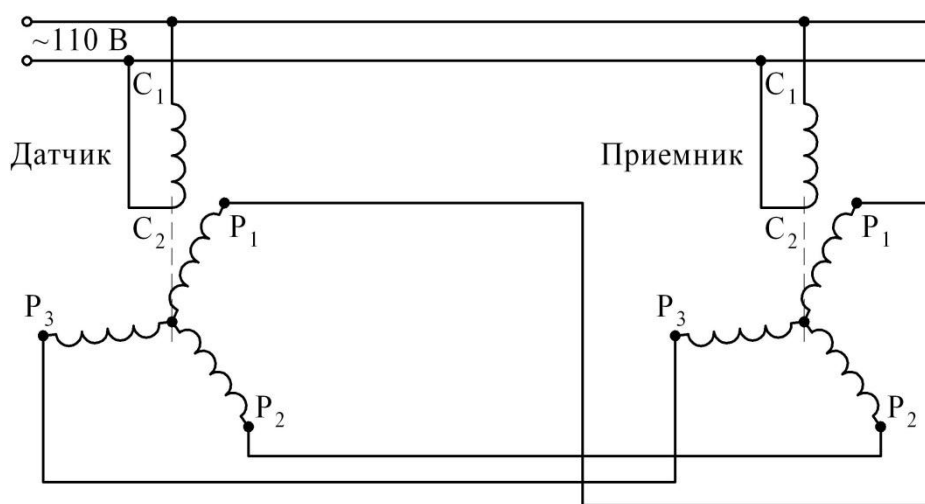
Рисунок 4. Принципиальная схема работы сельсинной пары в индикаторном режиме
