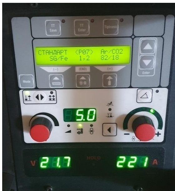
Рис. 2. Панель источника титания Lorch S8 SpeedPulse
