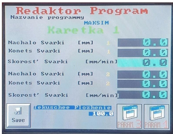
Рис. 5. Панель блока автоматического регулирования сварки Месоте
