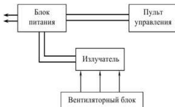
Рис. 3. Блок-схема рентгеновского аппарата РАП 160-5
