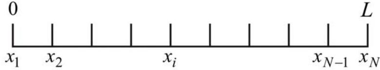
Рис. 2. Конечно-разностная сетка:
