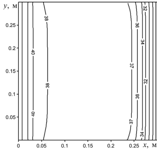
Рис. 31. Распределение температуры ( $^{\circ}\text{C}$ ) в пластине при  $t = 3600 \text{ c}$
