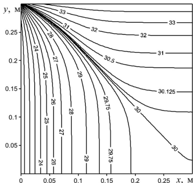
Рис. 28. Распределение температуры ( $^{\circ}\text{C}$ ) в пластине при  $t = 36000 \text{ с}$
