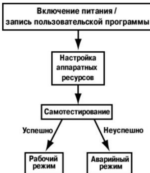
Рисунок 5.2 – Алгоритм запуска прибора
