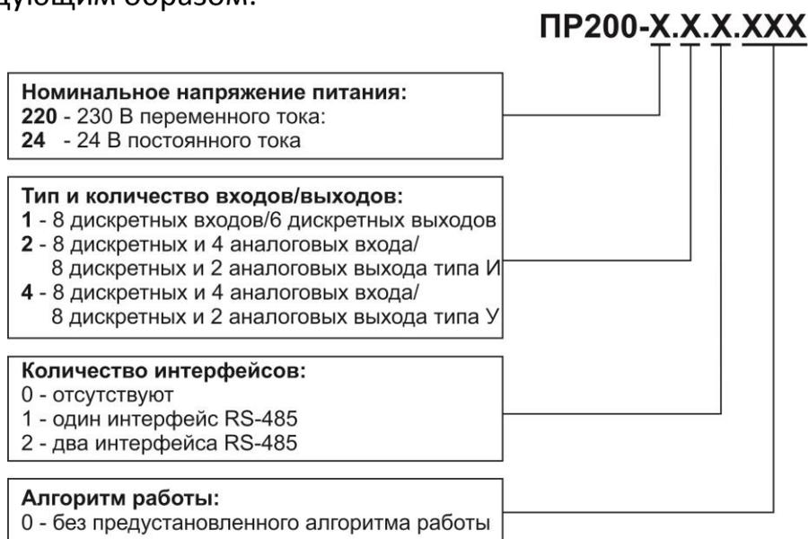
Рисунок 4.1 - Структура условного обозначения прибора
