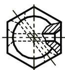
Болты могут иметь метрическую резьбу с крупным или мелким шагом. На рис. 8 показаны три исполнения болта с шестигранной головкой:
