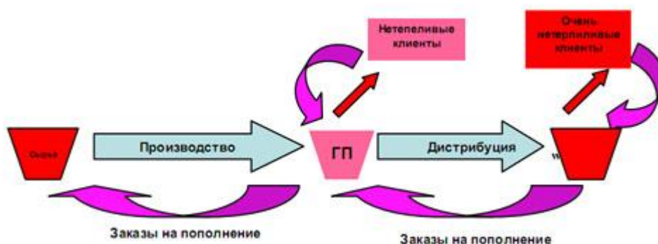
Рисунок 4: «Производство на склад» (MTS) – тип поставки для нетерпеливых клиентов.
