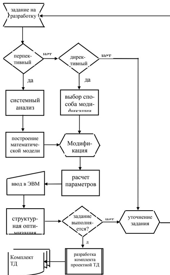
Рис. 4. Информационно-функциональная схема проектирования технологических процессов
