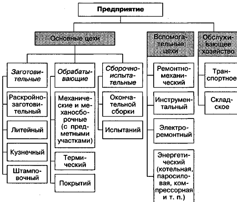
Рис. 7.2. Примерная производственная структура машиностроительного предприятия с предметно-технологическим принципом построения цехов
