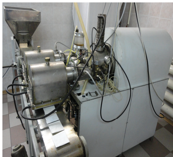
Рис. 1. Внешний вид первой модели СЭЛИ с транспортёром для размещения обрабатываемых образцов повязок
