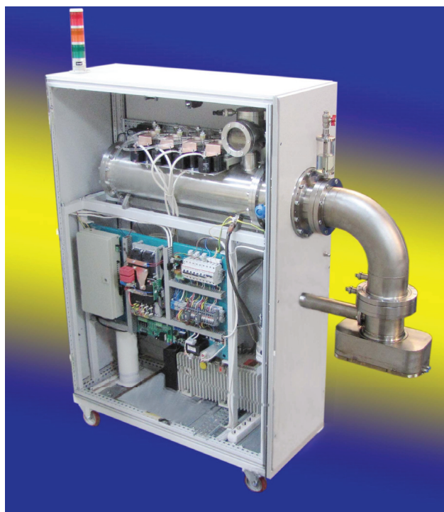
Рис. 2. Внешний вид последней модели СЭЛИ: при снятых дверках шкафа (1) с системой дистанционного компьютерного управления (2)
