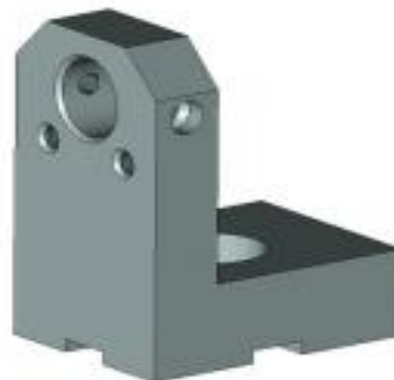
Угольник с установочным отверстием d12мм
