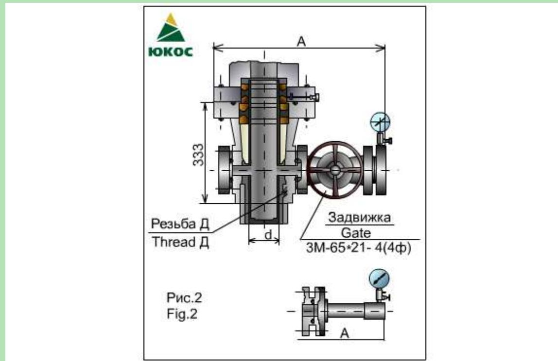
**ОКК2 – 350 – 168 × 245 × 324 К2** (обозначение оборудования обвязки колонн с клиньевой подвеской двух колонн, рассчитанное на рабочее давление 350 атм, диаметром эксплуатационной колонны 168 мм, диаметром промежуточной колонны 245 мм и кондуктора 324 мм для сред, содержащих  $H_2$  и  $CO_2$  до 6 %).
