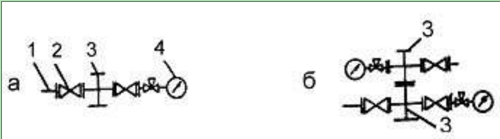
1 – ответный фланец; 2 – запорное устройство; 3 – трубная головка;
