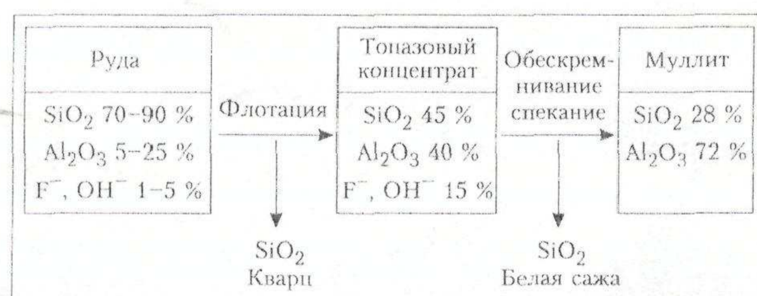
Рис. 1. Стадии переработки кварц-топазовой руды
