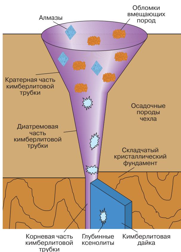
Рис. 2. Схематический разрез кимберлитовой трубки
