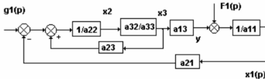
Запишем выражение для передаточной функции контура местной обратной связи:
