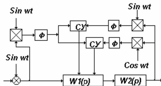
Сигналы определенной частоты выделяем из сигнала рассогласования на входе системы и одновременно на выходе системы. Сравниваем эти сигналы по амплитуде и фазе, и преобразованный сигнал этой разности вводим в корректирующее устройство  $\Delta W_1(p)$ . Для минимально-фазовых систем, у которых амплитудная характеристика однозначно
