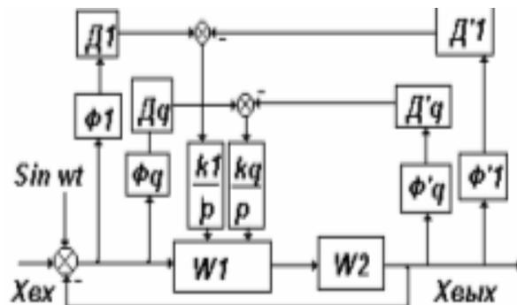
Гармоники с частотами  $\omega_1, \omega_2, \dots, \omega_n$  сигнала рассогласования выделяются узкополосными фильтрами  $\Phi_1, \Phi_2, \dots, \Phi_n$ . Гармоники с этими же частотами на выходе объекта выделяются фильтрами  $\Phi'_1, \Phi'_2, \dots, \Phi'_n$ . Затем сигналы детектируются на детекторах  $D_1, D_2, \dots, D_n$  – на входе системы и  $D'_1, D'_2, \dots, D'_n$  – на выходе системы.
