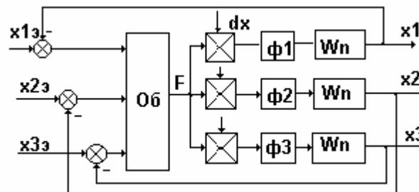
Таким образом структурная схема многомерной системы экстремального регулирования, работающая по методу градиента, состоит из трех астатических каналов с одинаковыми коэффициентами усиления.
