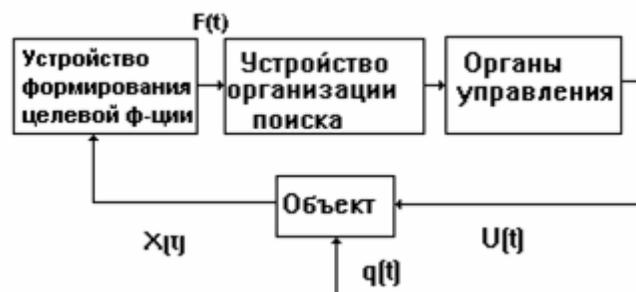
Как видим, структура поисковой экстремальной системы еще является одноконтурной, как и у большинства систем классической автоматики, хотя в структуру системы включаются новые функциональные блоки: устройства организации поиска экстремума, устройства формирования целевой функции, которые реализуют алгоритм адаптивного управления - удержание системы на экстремуме статической характеристики объекта.
