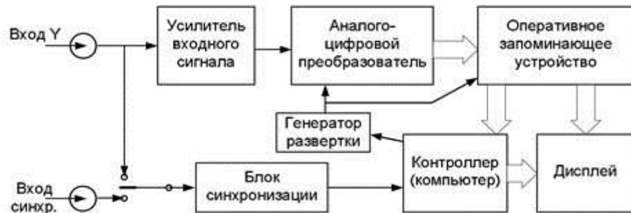
Рис. 9. Упрощенная структурная схема цифрового осциллографа
