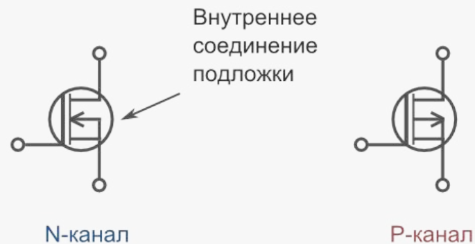
Обозначение на схеме MOSFET со встроенным каналом
