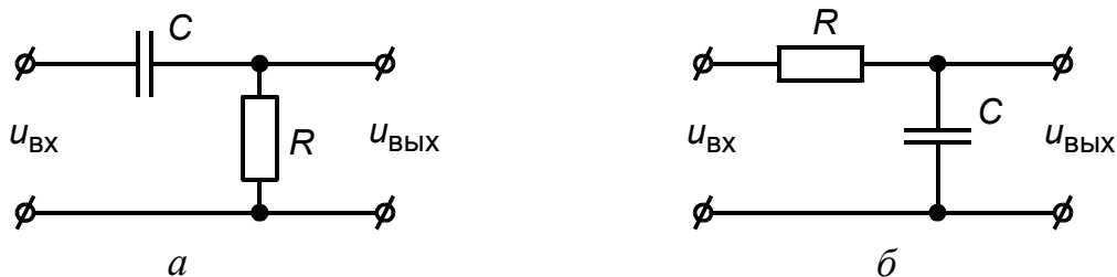
Рис. 4.2. RC – цепь, начинающаяся с конденсатора (а) и резистора (б).
