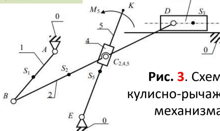
Рис. 3. Схема кулисно-рычажного механизма
